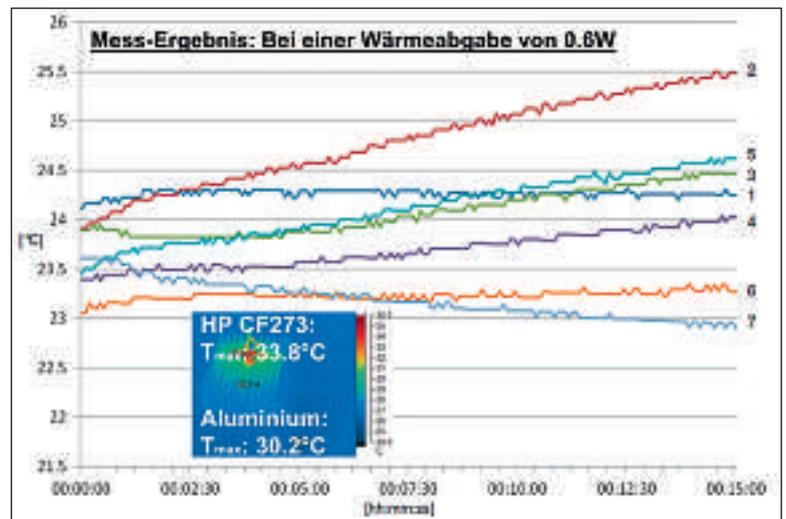
Die Wärmeleitfähigkeit von Hot Polymer CF 273 (Kurve 2) liegt im Bereich von Aluminium und ist deutlich besser als bei Wettbewerbsprodukten (Kurve 1 bis 7). (Bild: Rominger)
