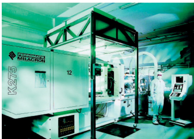
2: Durch den Einsatz von Flow-Box-Systemen entsteht im Reinraum ein Reinraum höherer Klasse
