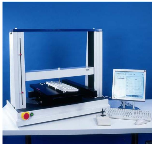
Prüfmaschine Modell 110S für die Prüfung von Tastaturen
